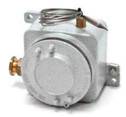
Капиллярный термостат EL-CTB предназначен для работы во взрывоопасных зонах в различных областях промышленности при обогреве трубопроводов, клапанов, сосудов и пр. Термостат EL-CTB выпускается для различных температурных диапазонов. Капиллярная трубка изготовлена из нержавеющей стали, прочный корпус сделан из алюминия и покрыт лаком.
