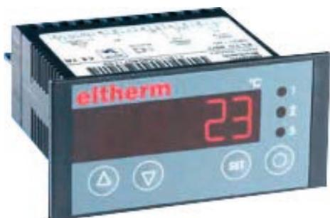
Терморегулятор с микропроцессорным управлением серии ELTC предназначен для контроля температуры и управления цепями нагрева в различных областях промышленности. Терморегулятор работает совместно с резистивным датчиком температуры типа Pt 100 (поставляется отдельно). Устройство оснащено сигнальными светодиодами, красным 7-ми сегментным 3-х разрядным цифровым индикатором, кнопочным управлением и настройкой. Оснащен одним управляемым выходным реле.
