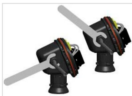
13. Установить сальник силового кабеля М25 (заказывается отдельно) и заглушку М25. Для линейного или Т-образного соединения установите дополнительную заглушку М25 (М25-В-ЕХЕ – заказывается отдельно) вместо сальника для силового кабеля.
